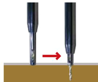
ガイド部の先端を、皿取面に垂直に当てドリルを押し込む事によりセンターに穴あけ出来ます。
