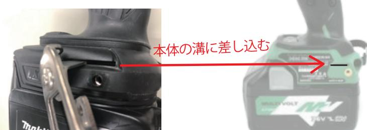
②インパクト本体のビス穴とハンガーのビス取付け穴を合わせて付属の専用ビスで取り付けて下さい。
