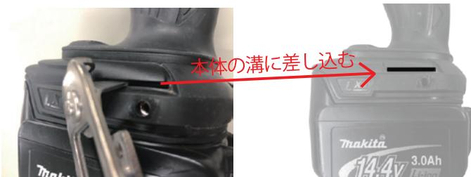
②インパクト本体のビス穴とハンガーのビス取付け穴を合わせて付属の専用ビスで取り付けて下さい。
